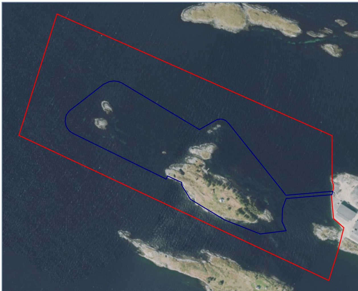
Figur 6: Raud linje syner varsla planavgrensing. Blå linje syner areal som vert landareal etter utfylling (GisLink/iVest Consult AS)
